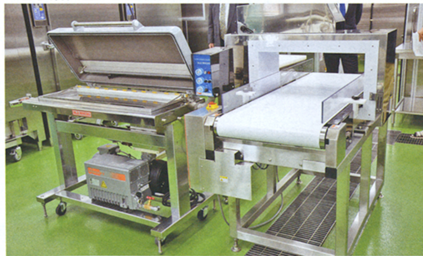
竣工した水産加工センター。下は二次加工室の真空包装機(左)と金属探知機
